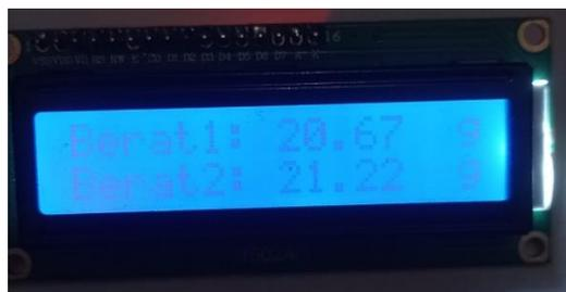
Gambar 8. Pengujian sensor load cell pada LCD
