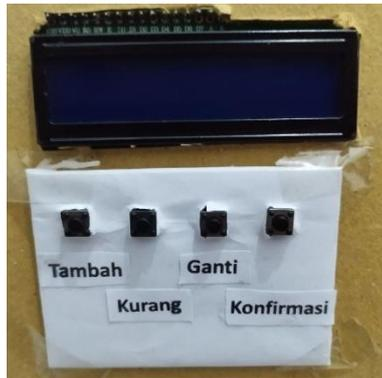
Gambar 11. Pengujian push button
