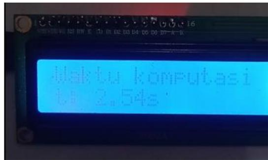
Gambar 13. Pengujian response time sistem pada LCD
