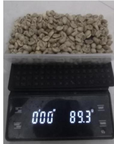
Gambar 9. Pengujian sensor load cell pada timbangan digital
