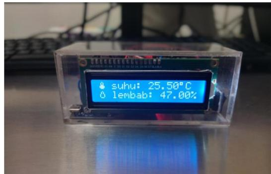
Gambar 2b. Produk jadi rakitan perangkat *LSTM-IOT*
