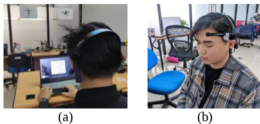
Gambar 7. Implementasi Perangkat Keras: (a) Keseluruhan perangkat, (b) Penggunaan headset EEG Neurosky Mindwave Mobile 2
