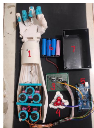
Gambar 5. Implementasi Lengan Prostetik Bionik
