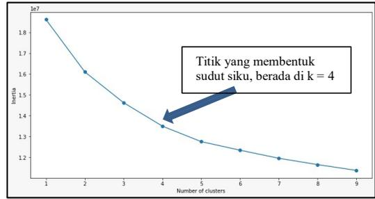
Gambar 7. Penentuan jumlah kluster dengan *elbow method*
