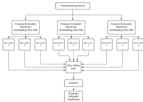
Gambar 3. Skenario Eksperimen
